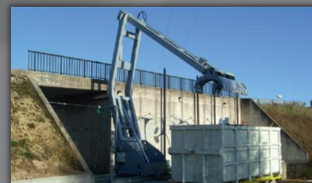
Dégrilleur mobile à déchargement en benne
